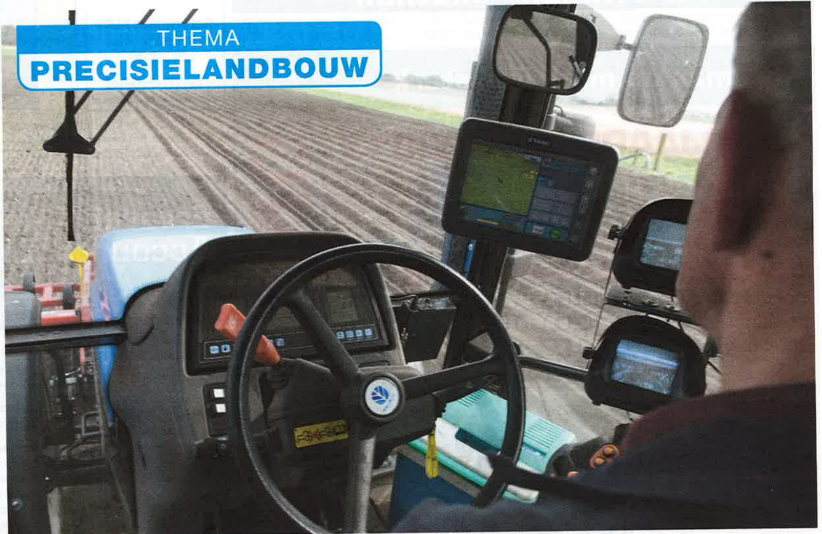
Kaasrecht aardappelen poten met behulp van het rtk-gps-systeem.
