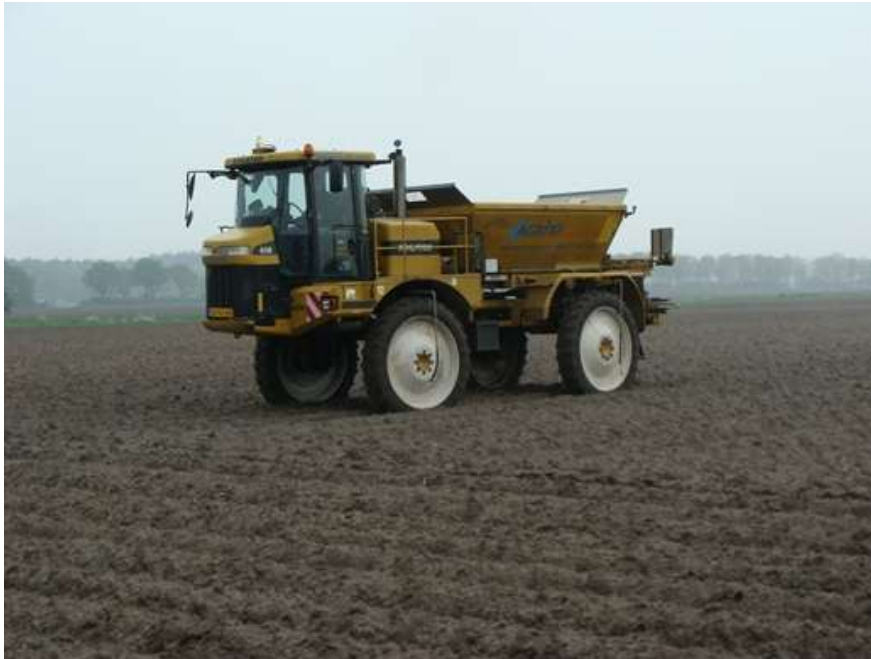
Figuur 8. Challenger Rogator van Timmermans Agri Service waarmee plaatsspecifiek een overbemesting werd uitgevoerd met KAS 27% N.
