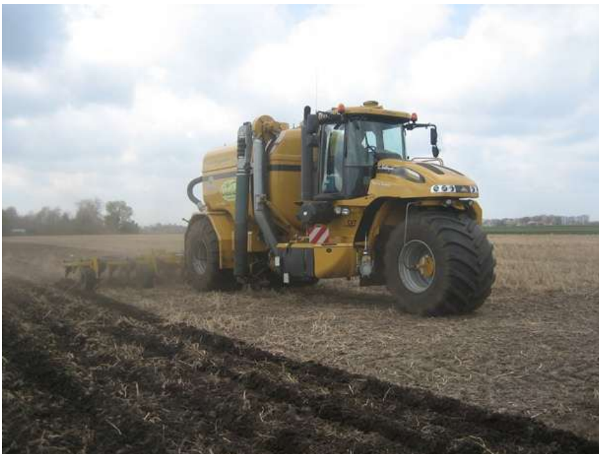
Figuur 7. Challenger Terra Gator TG 8333 CVT van loonbedrijf Geelen voorzien van dGPS automatische besturing.
