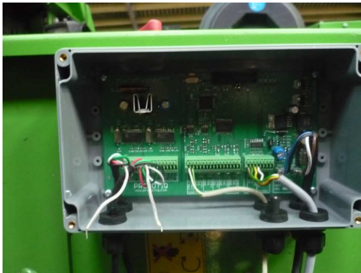
Figuur 8. Plaatsing controller aan de zijkant van de leesband op de AVR Puma+ rooimachine.
