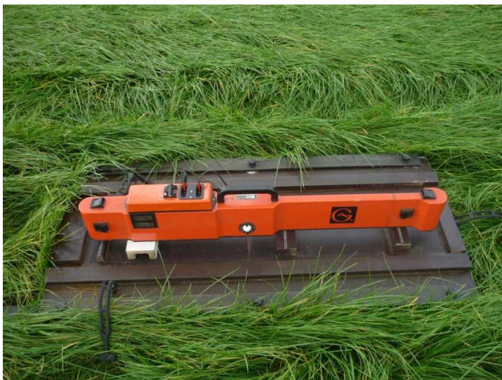
Figuur 4. EM38 MKII sensor op houten slede.
