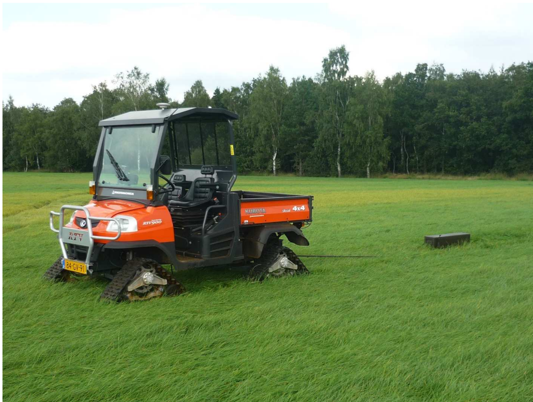
Figuur 5. De Kubota RTV-900 op rupsen met daarachter de EM38-MK2 bodemsensor op slede.
