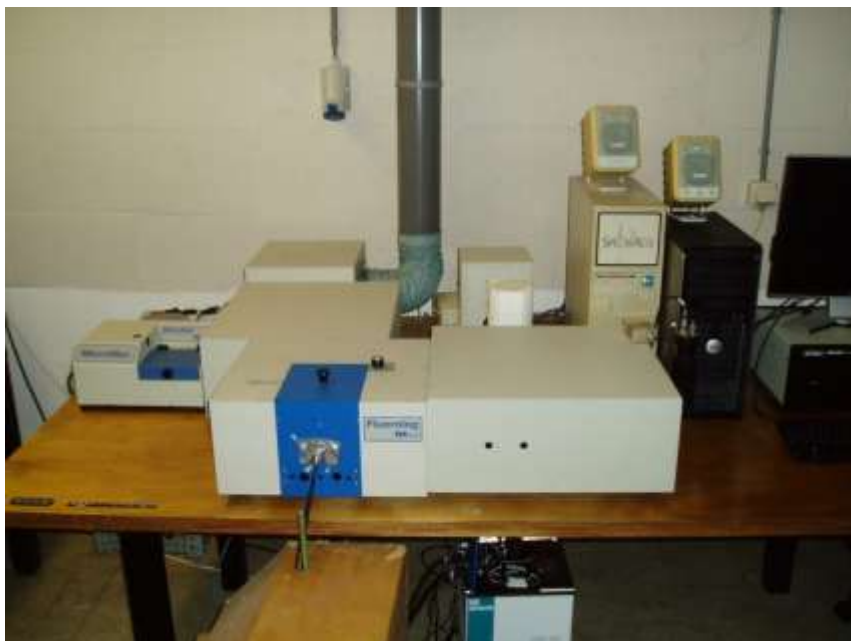
Figuur 4: Fluorimeter gebruikt in de experimenten. Op de achtergrond staat de lamp.
